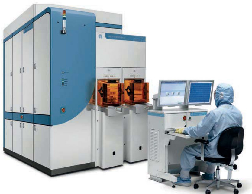
Beispiel für ein Halbleiter-Wafer-Fertigungssystem mit Ethercat
