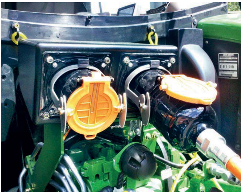
Schnittstelle mit einseitig gesteckter Anschlussleitung zum Anbaugerät
