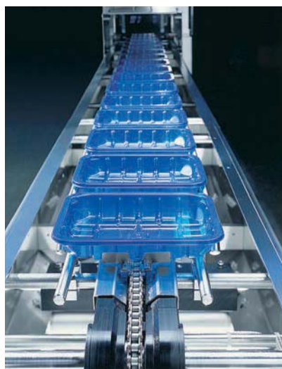
Traysealer versiegeln befüllte Schalen, wobei das Befüllen an der Maschine oder räumlich getrennt von ihr erfolgt.
