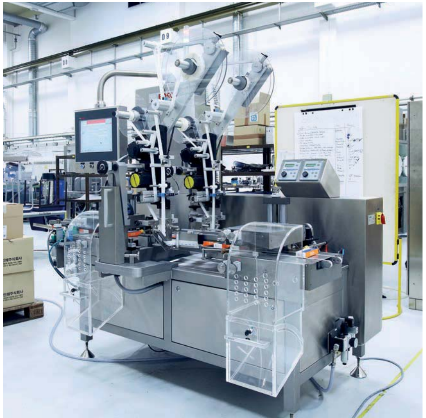
Mit der Baureihe CPS bietet Bosch Packaging den Kunden kompakte und modular kombinierbare Bedruckungs- und Verifizierungslösungen für Faltschachteln, die auch nachträglich noch erweitert werden können.
