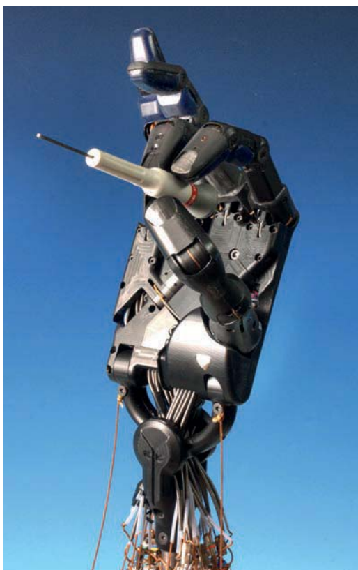
Die Dexterous Hand ist mit 129 Sensoren ausgestattet.
